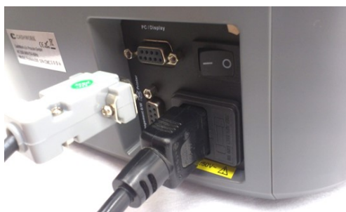
Câble RS232 mâle sur le port PC/Display à l'arrière de votre Pronote200.
